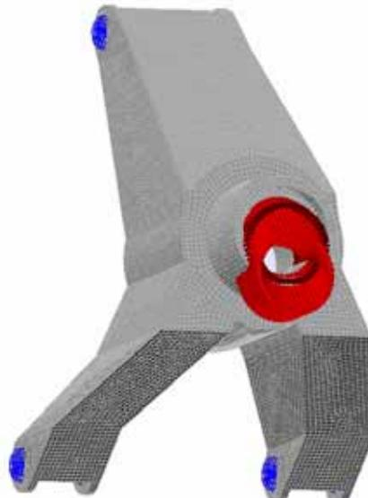
Figura 9 (modello FEM): vincoli e forze in accelerazione laterale (in curva).
