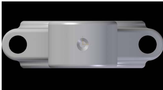
Figura 10 dettaglio foro lubrificazione
